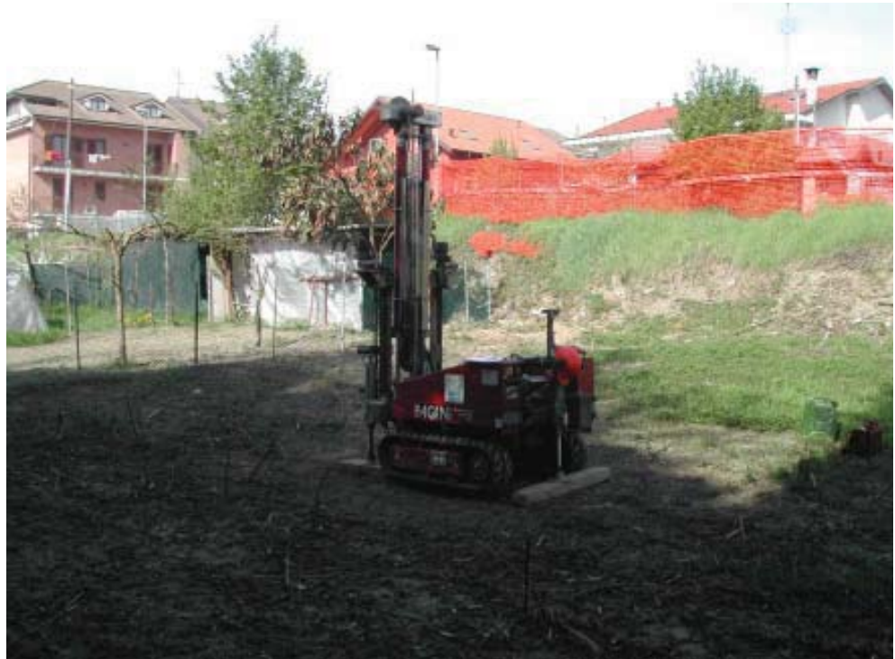
FOTO 1: L'ubicazione della prova penetrometrica P1, spinta alla profondità di 9.20 m dal p.c.
