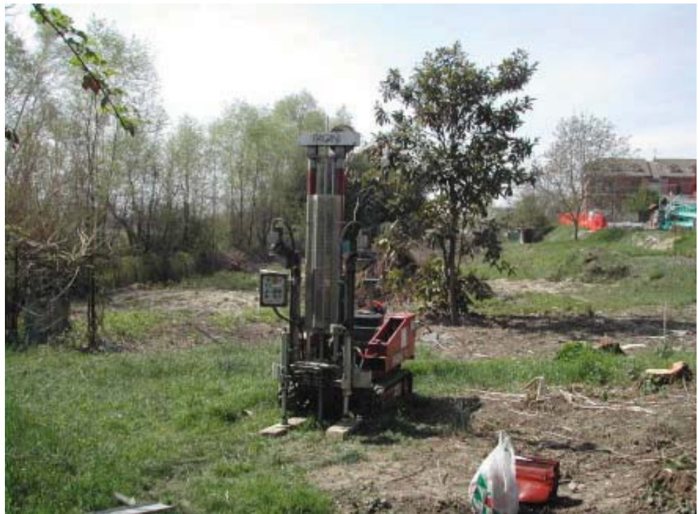
FOTO 2: L'ubicazione della prova penetrometrica P2, spinta alla profondità di 9.20 m dal p.c.
